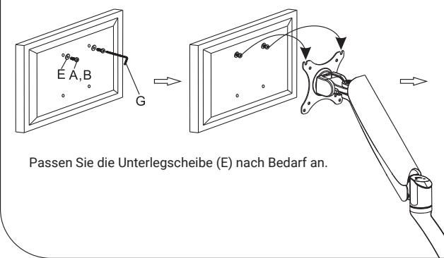
Passen Sie die Unterlegscheibe (E) nach Bedarf an.
